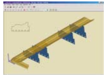
Vorrichtungen zur Aufnahme des Werkstücks werden von proLAS-3D automatisch konstruiert.
