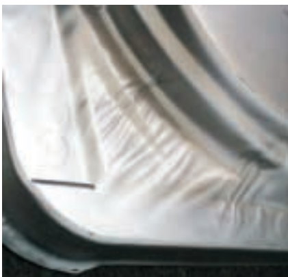
Eine erfahrungsbasierte Prävention von Fehlern wie dieser Faltenbildung verkürzt den Prozessanlauf erheblich.
