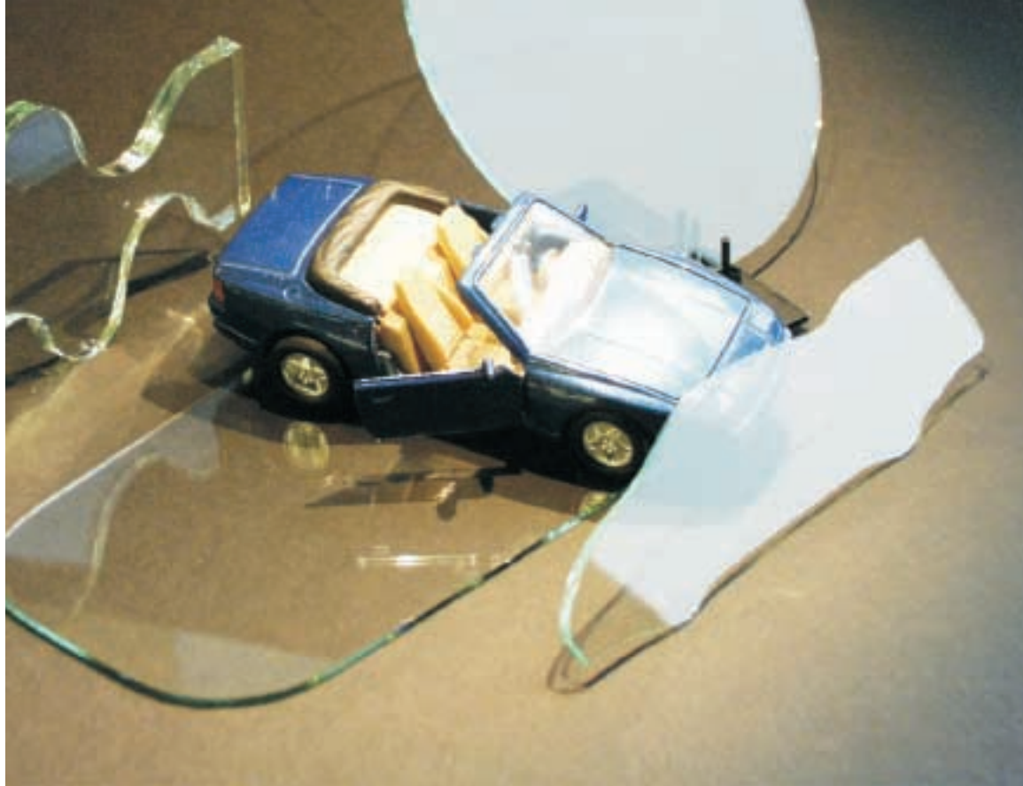
Ein neu entwickeltes Laserstrahlverfahren ermöglicht das Schneiden von Konturen aus Flachglas.
