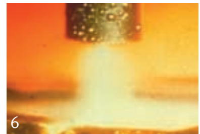
6 Mit kaltem Wasser und scharfem Sand lassen sich viele Materialien bearbeiten.
