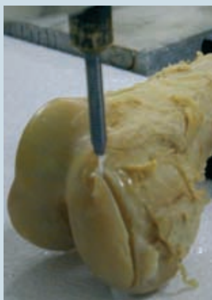
Nasses Skalpell: In der Medizin kann der Wasserabrasivstrahl beispielsweise zum Schneiden von Knochen eingesetzt werden.
