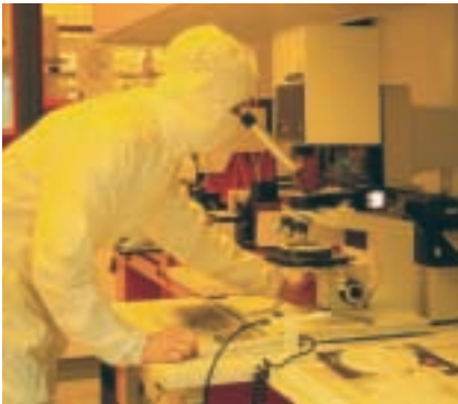
Ein Mikrotechnologe überprüft am Mikroskop im Reinraum die gefertigten Bauteile auf einem Wafer.
