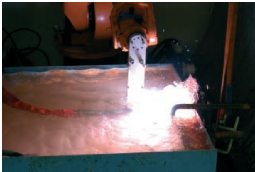
Plasmaschneiden: Bei Druckkammerschneidversuchen wird 130 mm dicker Stahl in 4 m Wassertiefe sicher getrennt.
