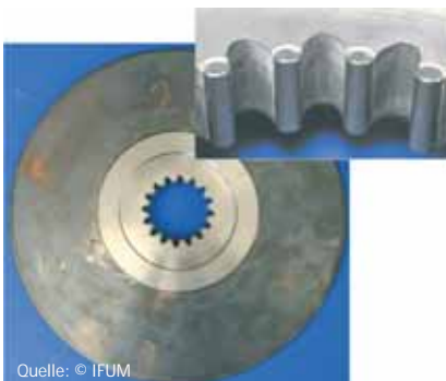
Armierte Matrize mit eingelöteten Keramikzylindern zum Präzisionsschmieden von geradzahnten Modellzahnradern.
