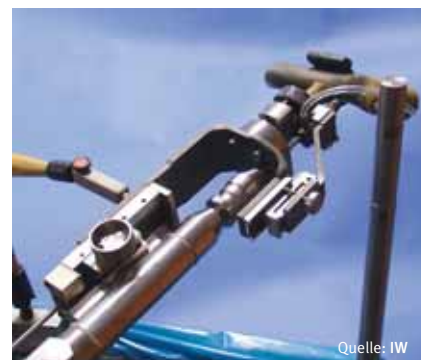
Bild 2: Die Implantatbohrmaschine im Versuch: rechts oben der Greifer an der Knochenattrappe, davor der Schlauch der Spülvorrichtung.
