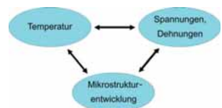
Bild 1: Kopplung von Temperatur, Mikrostruktur und Deformation.
