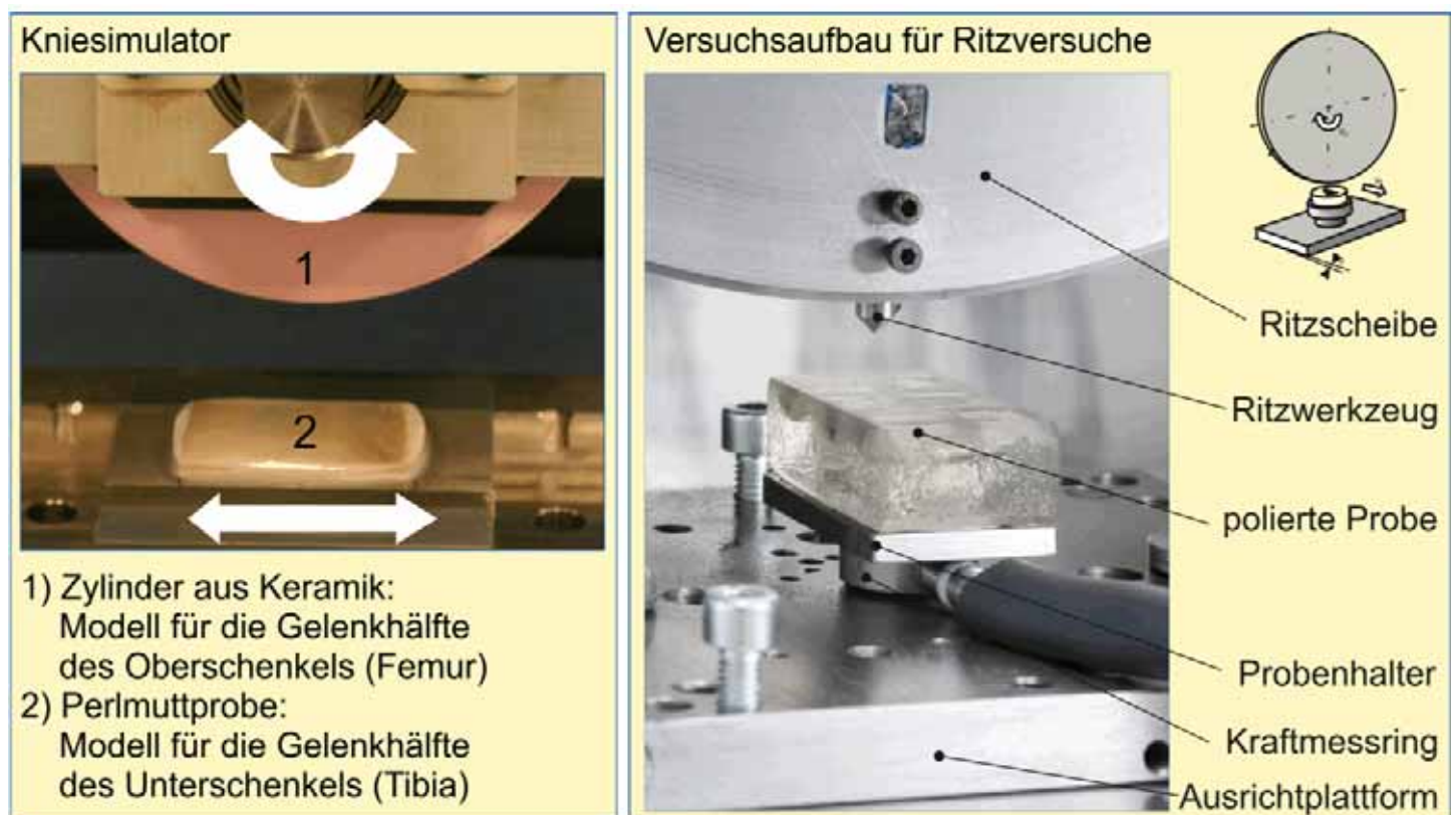
Bild 3: Materialprüfung (links) und Materialbearbeitung (rechts) sind zwei wichtige Schritte bei der zukünftigen Herstellung von Implantaten aus perlmuttähnlichen Hybridmaterialien. Die Materialprüfung wird durch einen Knie-Simulator durchgeführt. Die ersten Aussagen über die Zerspanbarkeit vom Perlmutter können im Anschluss an die Ritzversuche getroffen werden. (Quelle: IFW)
