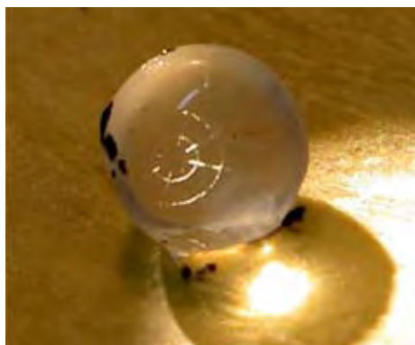
Extrahierte Linse mit acht Gleitebenen, die von einem Femtosekundenlaser eingebracht wurden. (Quelle: LZH)
