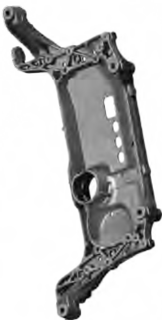
Bild 1: Einteiliger Hilfsrahmen gegossen aus einer Aluminiumlegierung für den Passat B6 und den Audi TT-Nachfolger (Quelle: VW)
