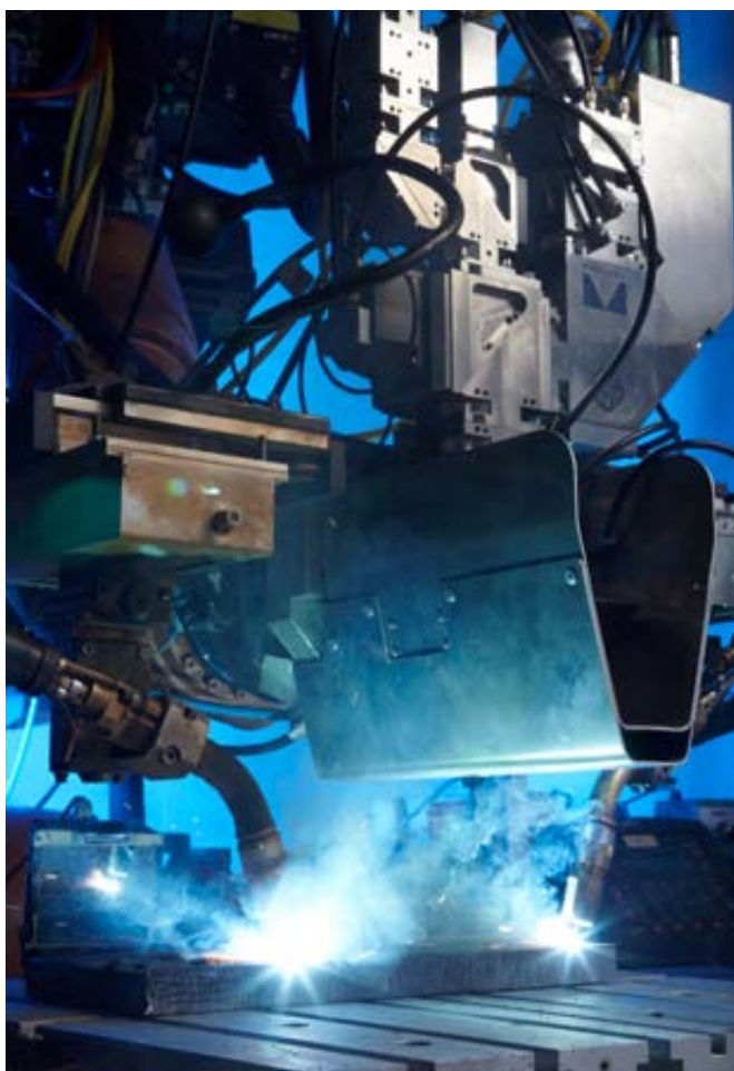
Bild 1: Versuchsaufbau mit Bearbeitungskopf des Laserstrahl-MSG-Hybridschweißprozesses (Quelle: LZH)
